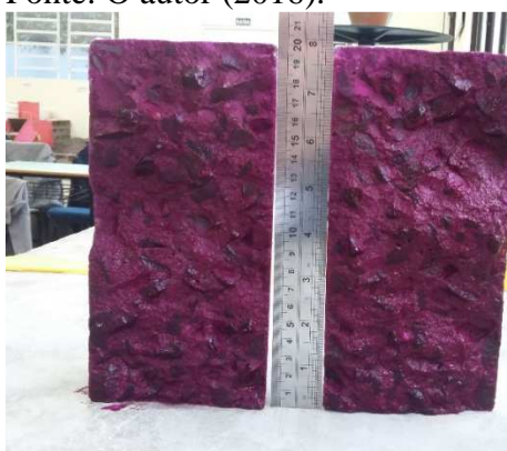
Figura 8. Ensaio de Carbonatação em RE6.
