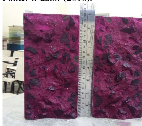
Figura 9. Ensaio de Carbonatação em RR6.
