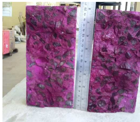
Figura 7. Ensaio de Carbonatação em RR4.
