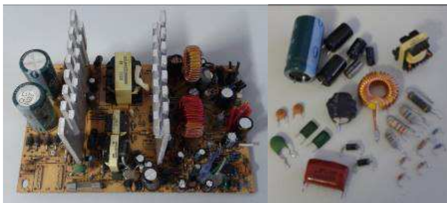
Figura 2. Fonte de computador e alguns de seus componentes dessoldados. Fonte: dos autores.
